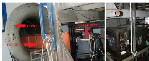
Instalație experimentală de alimentare cu amestec ulei camelina / kerosen
