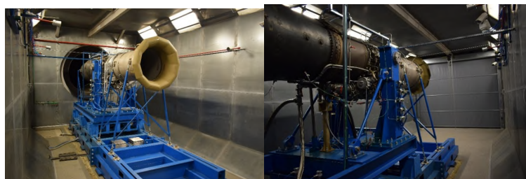
Celula numărul 2 de testare motoare turboreactoare și turboventilatoare
